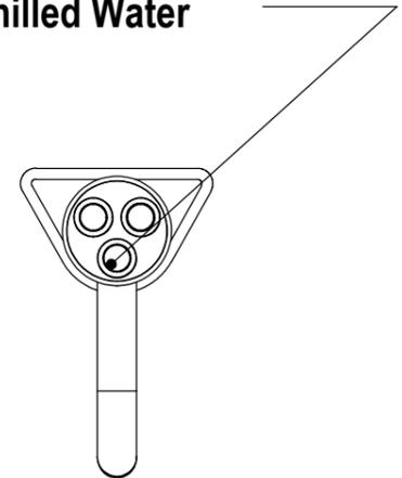
**FORO DI INSTALLAZIONE  $\phi$  35 MM**
